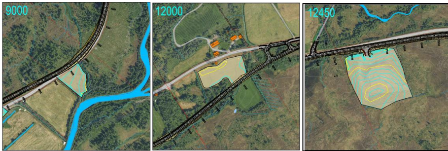
Figur 6-20: Oversiktsbilete som viser nokre vurderte og forkasta masselager. Profilnummer er skrivne i toppen av bileta. Kjelde: Sweco.
