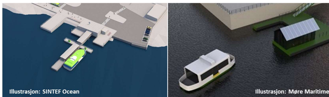
Figur 4: Konseptuelle løsningsforslag for flytekai i «T» form for Ålesund, og «C» form for Kristiansund
