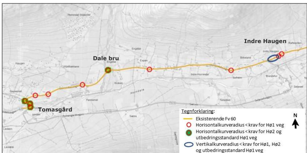
Figur 6 Kurvatur eksisterende veg vestre del
