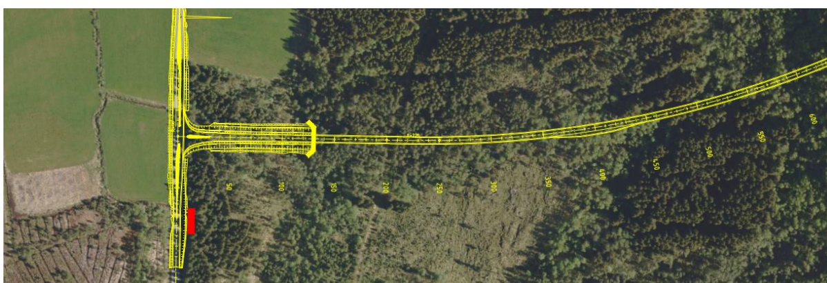
Figur 37 Vegskisse av A Lykkja, nytt kryss på rv. 70 og starten av ny tunnel (Sweco).
