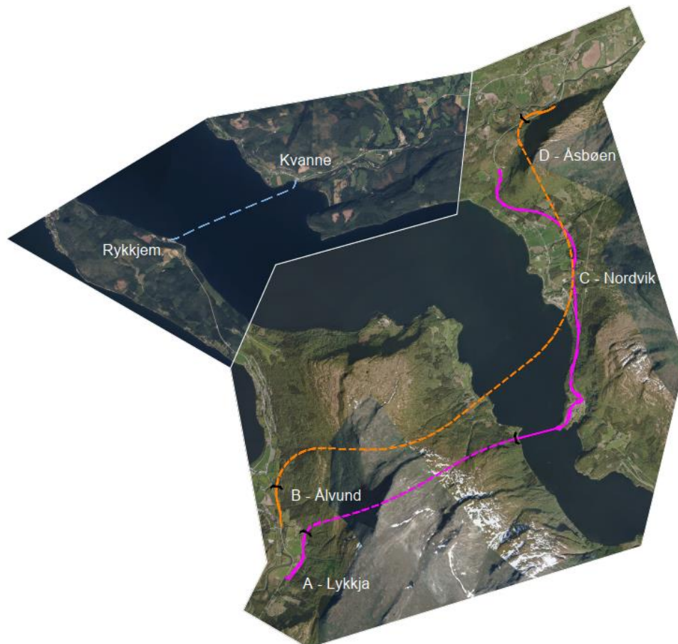
Figur 51: Vurderte alternativer; alternativ 1- undersjøisk tunnel (oransje) mot alternativ 2 – tunnel og hengebru (rosa)
