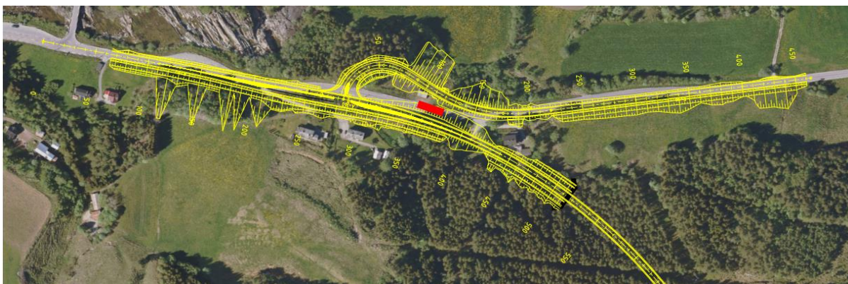
Figur 39: Vegskisse over dagsonen B Ålvund øvre, eksisterende kryss mellom rv. 70 og fv.670 i øvre venstre hjørne (Sweco).
