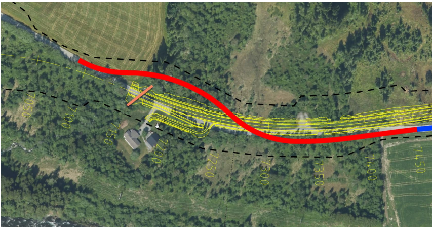
Figur 7: Trafikkavvikling ved bygging av Sva bru, svart stiplet strek er anleggsgrensa.
